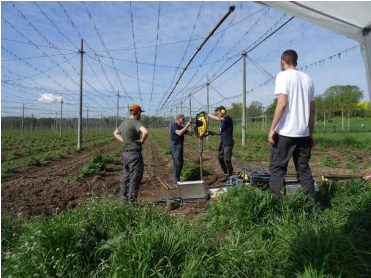
Die Sedimente der Weißen Elster werden mit Rammkernsondierungen erkundet. Foto: Hans von Suchodoletz/Universität Leipzig
